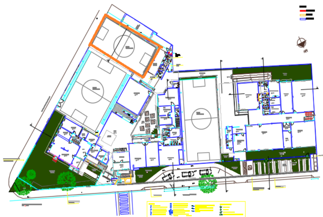
Figura 6: Vista em planta da Unidade II com destaque na área de captação de água pluvial. Fonte: Gomes (2016)
